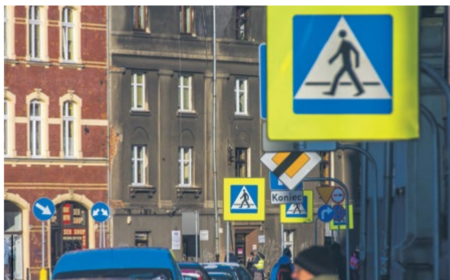
Umieszczenie znaków na fluorescencyjnym tle sprawia, że są lepiej widoczne dla kierowców
